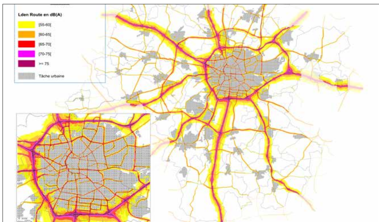
Figure 3 : Carte de type «a» 2021 : représentation des émissions sonores du bruit routier issues des calculs (indice L_{den} )
