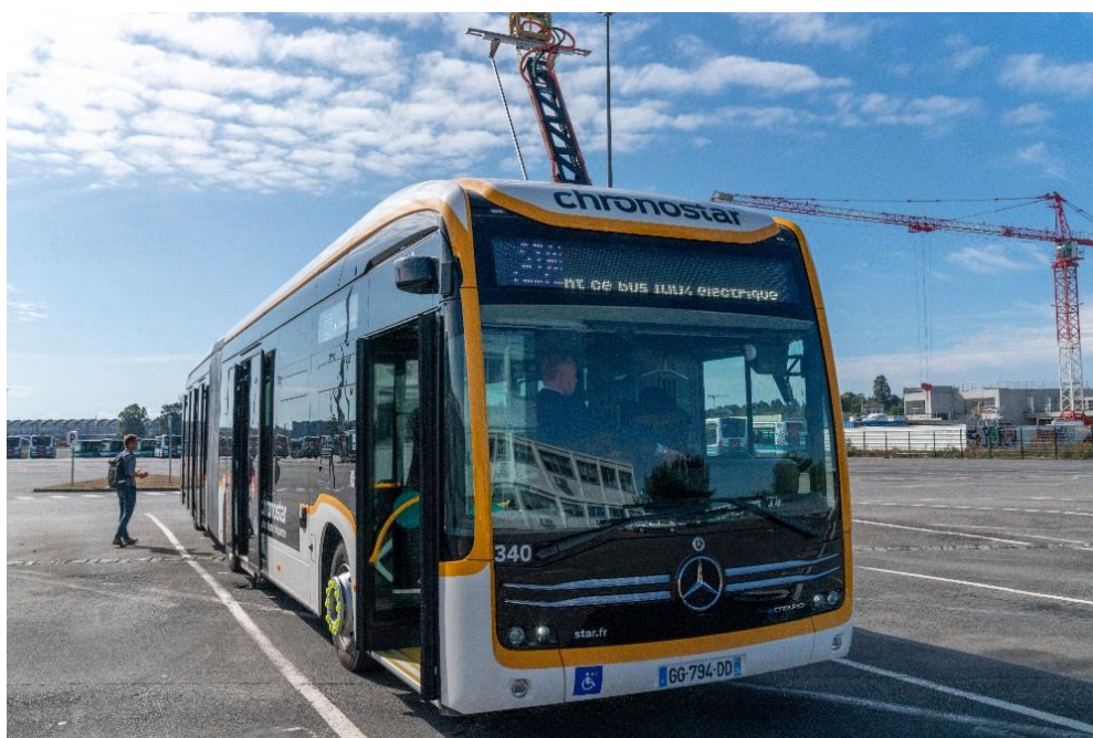
Bus électrique articulé avec pantographe relevé
