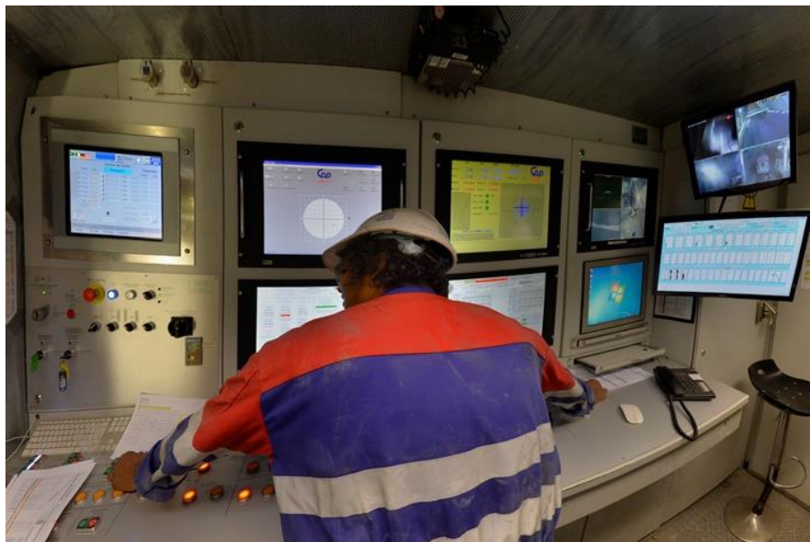
Cabine de pilotage du tunnelier © Jean-Louis Aubert
