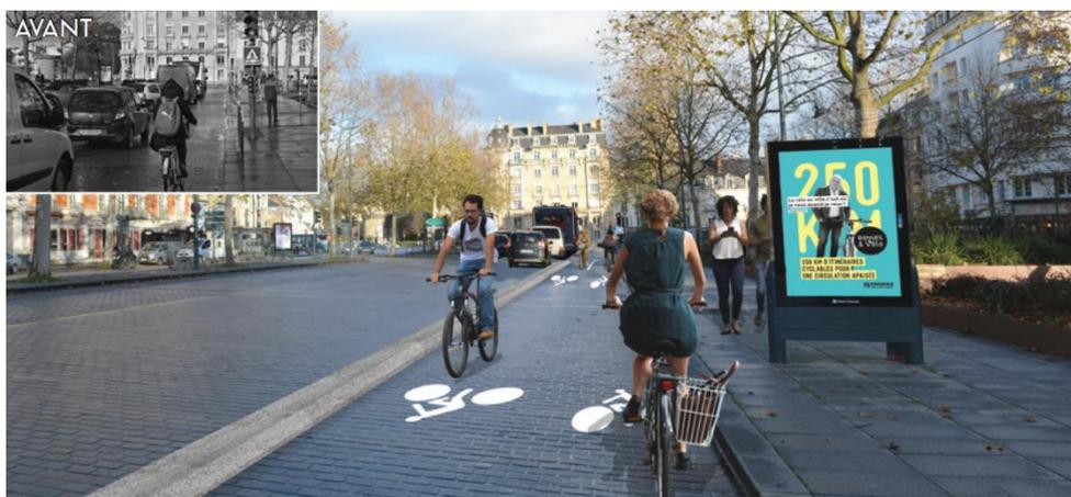
Sur la rive est de la place de Bretagne, une piste cyclable bidirectionnelle a été créée, séparée de la circulation automobile réduite à deux files par une bande de granit de 10 cm de haut et 60 cm de large.
